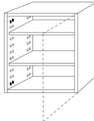
Sur un meuble de rangement avec une porte avant, le Push-Open doit être monté dans les trous des charnières, si possible à la hauteur où vous pousserez la façade avant pour ouvrir. Par exemple, au bas d'une armoire haute et au sommet d'une armoire basse. Et sur un meuble de rangement haut, à environ 120 cm du sol.
