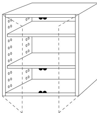
Sur un meuble de rangement à deux portes, le Push-Open est de préférence monté dans la structure. Si ce n'est pas possible, le monter sur une étagère fonctionnera également.
